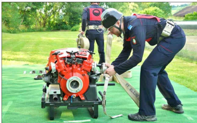
Abb. 42: Ankuppeln und Auslegen des ersten B-Schlauches (LFV Stmk. BR d.V. Franz Fink)
