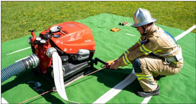
Abb. 39: Richtiges Befestigen der Saugschlauchleine (LFV Tirol)
