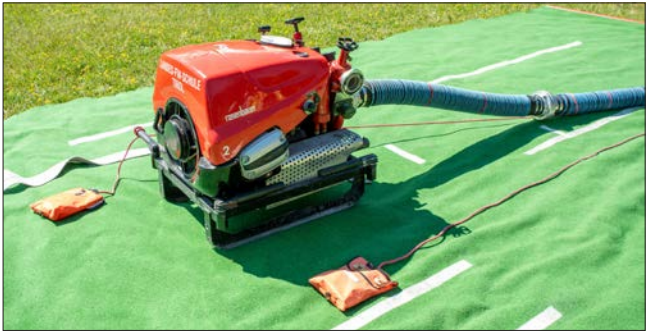
Abb. 40: Ablegen des Leinenbeutels mit der Ventilleine (LFV Stmk. BR d.V. Franz Fink)
