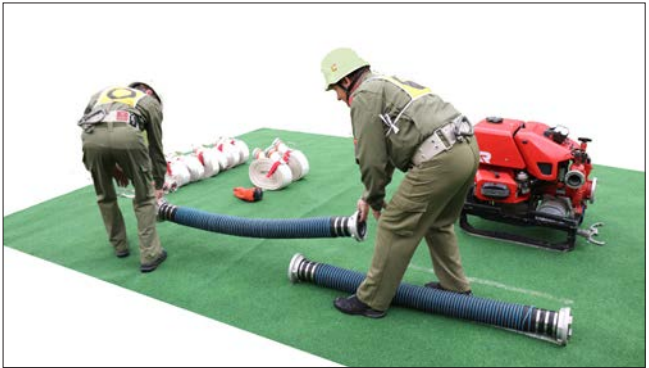
Abb. 18: Auslegen des Saugschlauches durch den STR (5 und 6) (ÖBFV)
