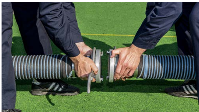
Abb. 29: Kuppeln der Saugschläuche mit angesetzten Kupplungsschlüsseln (ÖBFV)
